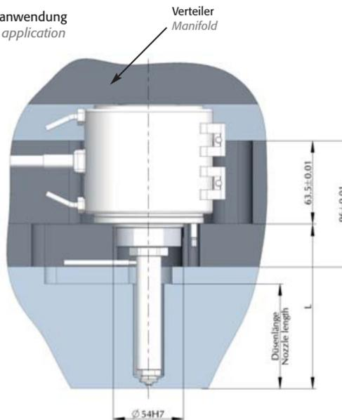
Fixierung der NI-Düse erfolgt über die Trennebene
